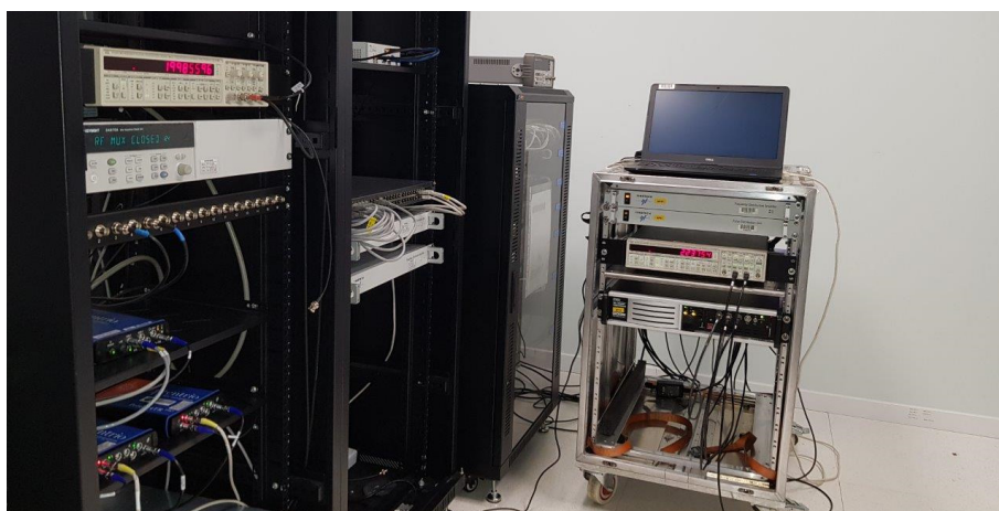
Figura 4.12: Calibrador GPS viajero del BIPM, durante la calibración en el ROA en diciembre de 2018.
