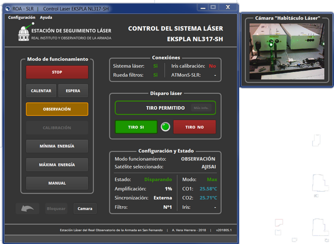
Figura 3.5: Presentación del programa de control de la estación láser NL-317. La imagen superior derecha muestra los dos bancos láser instalados sobre el tablero óptico.
