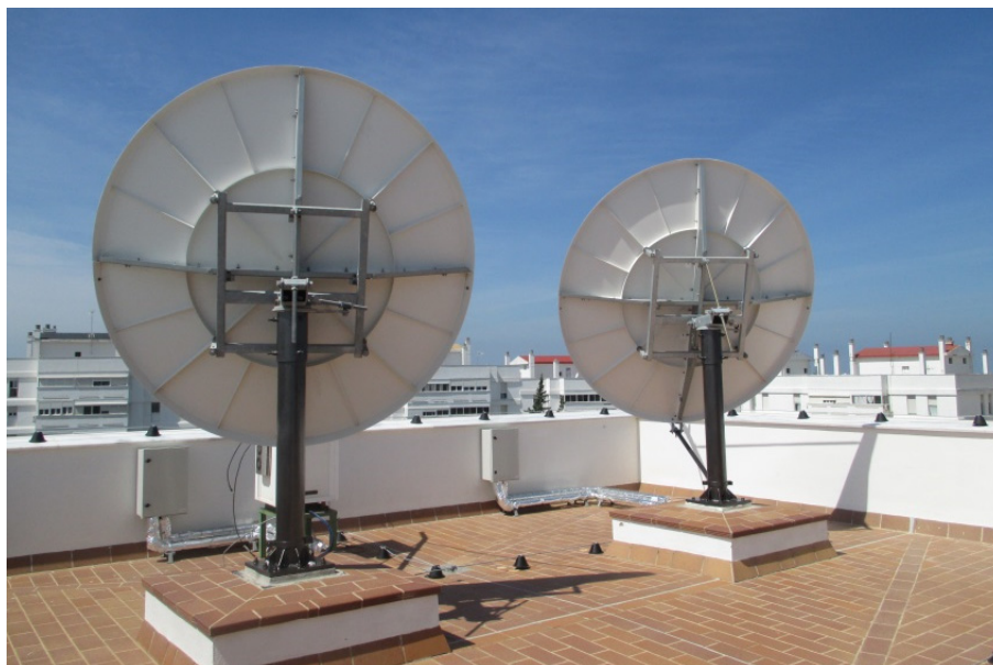
Figura 4.7: Antenas de la estación 1 (izqda.) y estación 2 (dcha.) del sistema TWSTFT, en la azotea del nuevo laboratorio.
