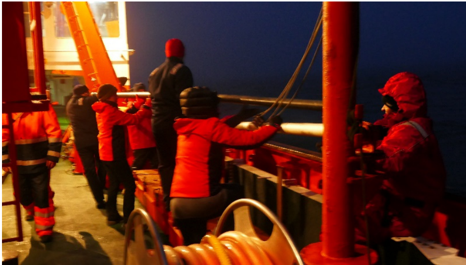
Figura 3.18: Maniobra de lanzamiento de una sonda de toma de muestras de sedimento del fondo marino. Una de las formas más efectivas de obtener información sobre el clima del planeta hace millones de años.
