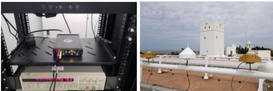
Figura 4.12: Estación GNSS de SMD (Bélgica) constituida por una antena PolaNt Choke Ring B3/E6 (antena color blanco, dcha.), un receptor PolaRx5TR (izq.) y 100 m de cable de antena FSJ2-50.
