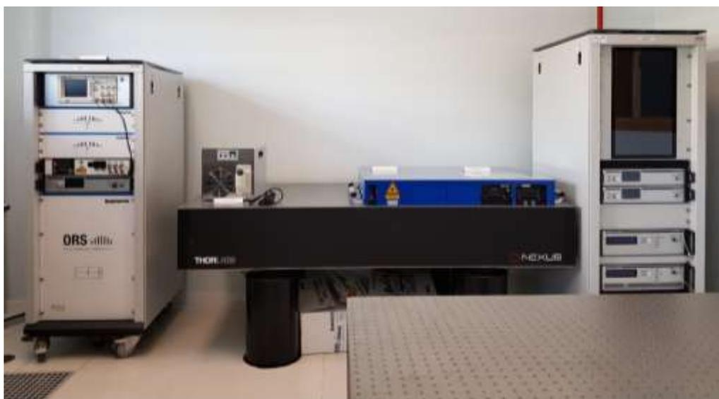
Figura 4.14: Sistema de Referencia Óptico (ORS) y peine de frecuencias ópticas del proyecto CIROEs.
