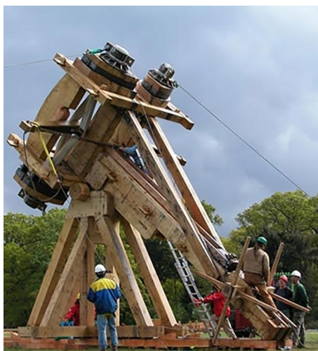
Fig. 5.11. Balista construida con patrocinio de la BBC en 2002. Lanza proyectiles de un talento, 28,5 kg y pesa 12 TM. No alcanzó ni los 100 m en las pruebas, posiblemente por la construcción de los muelles
