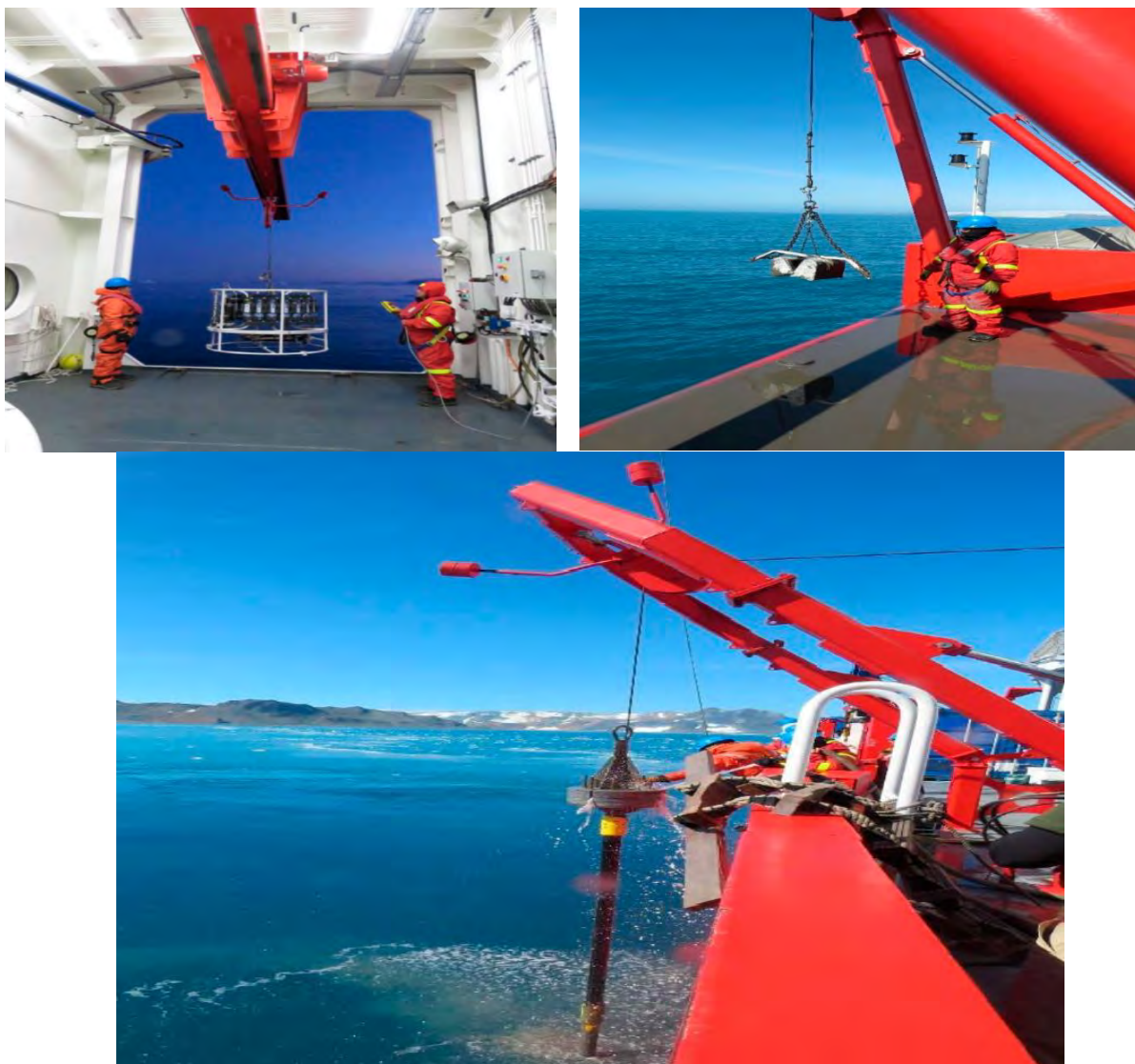
Roseta oceanográfica SBE, Draga Van Veen y Piston Corer
