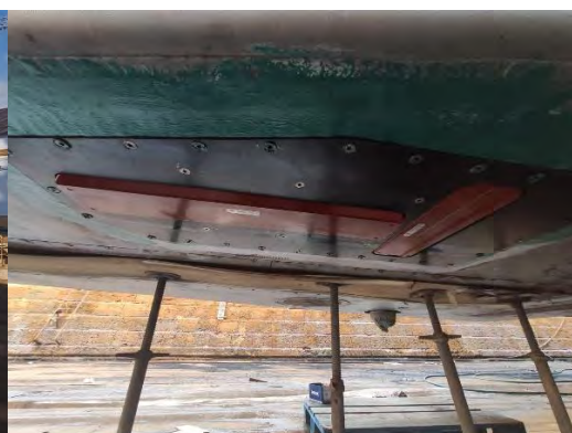
Instalación del sondador multihaz EM2040 MKII
