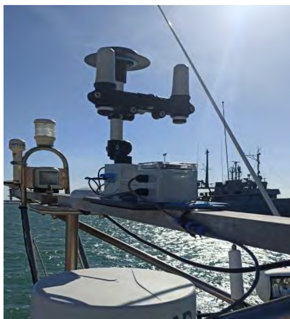
Instalación del DeepMotion de la UPM en las lanchas
