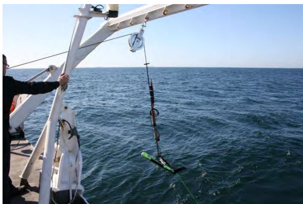
Maniobra de arriado de SBL para exploración de rasgo del fondo marino
