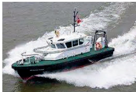
Fig. 4. Lancha hidrográfica de tamaño medio, de eslora 13 metros aproximadamente (fuente: Barco Stan tender 1505 del Astillero holandés Damen).
