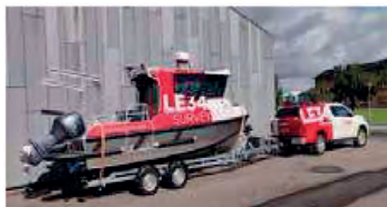
Fig. 3. Lancha hidrográfica de menor porte, 9 metros aproximadamente, transportable por tierra (fuente: empresa Danesa Le34).
