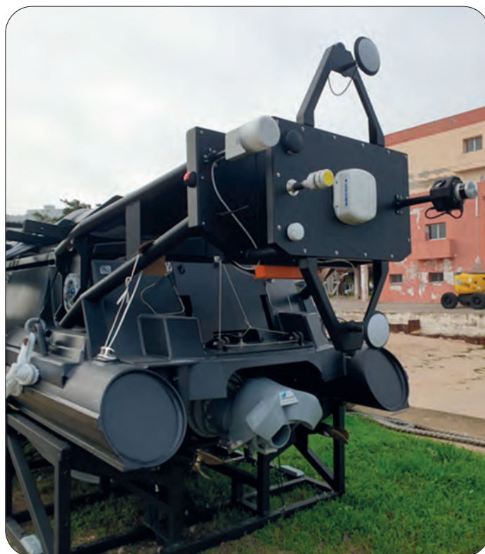
Detalle sensores y sistema propulsión SONDA-01
