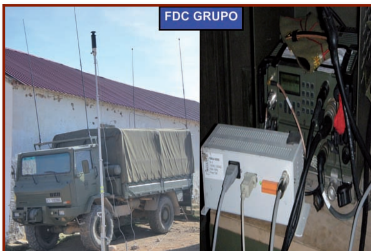
Fig. 3. Estación meteorológica y conexión a PR-4G
