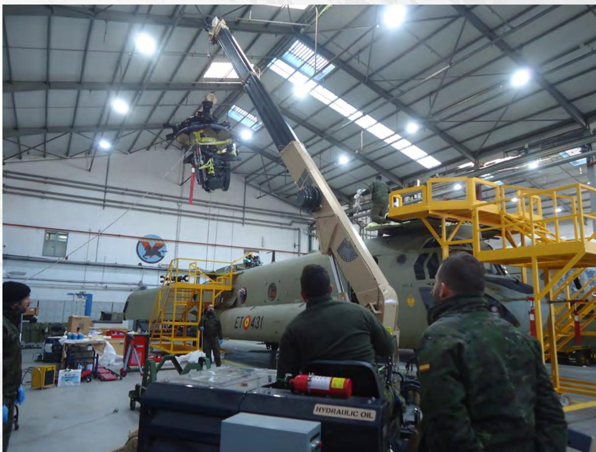
Montaje del paquete delantero en el ET-431 a la par que cogiendo destreza con la «spidercrane»
