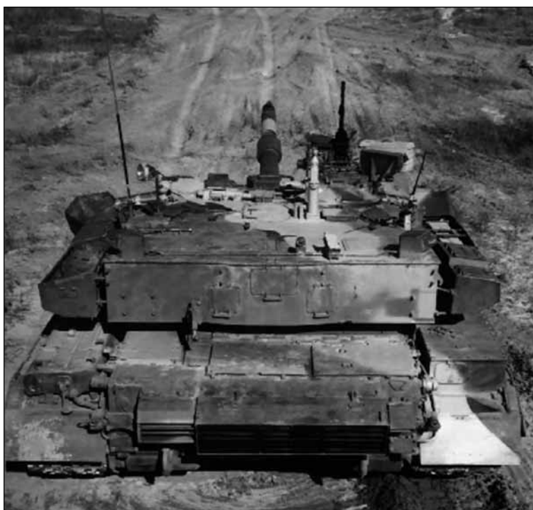
En esta vista del «Oplot» se puede apreciar el nuevo diseño de la torre con el cargador automático situado en la parte trasera.
