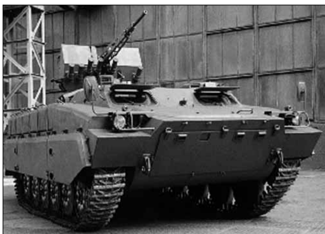
El cañón de 30 mm. y la coraza reforzada convierten al «MT-LB» en un verdadero vehículo de combate.
