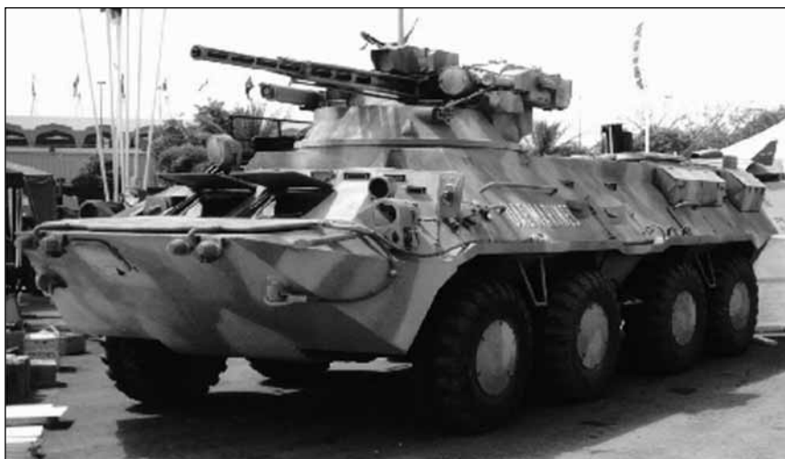
La torre modular «Shkval» fue diseñada expresamente para el BTR-3U «Guardian», habiéndose estudiado para montar diferentes tipos de armas.
