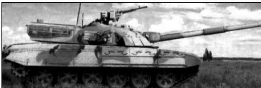
En esta vista lateral del «T-72-120» se puede ver el alargamiento posterior de la torre, necesario para instalar el cargador automático.
