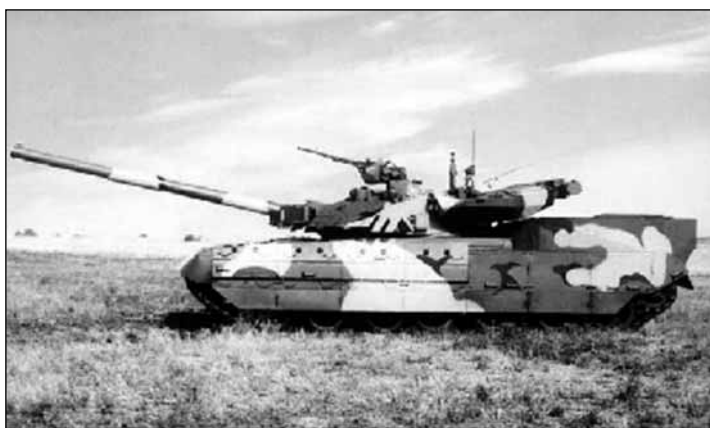
Al igual que en el caso del «BMT-72», el vehículo de combate pesado «BMPT-84» mantiene la torre con cañón de 125 mm.
