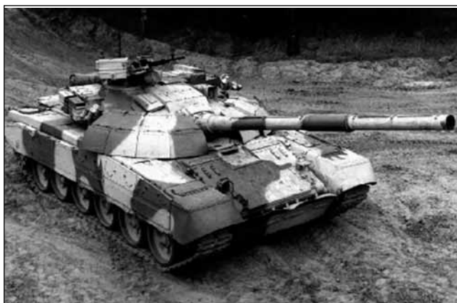
Como se puede apreciar, el «T-72AG» incorpora coraza reactiva ERA de nuevo diseño.
