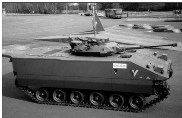
*El prototipo experimental británico «ACVP» monta una coraza ligera a base de materiales compuestos (plásticos y cerámicas).*
