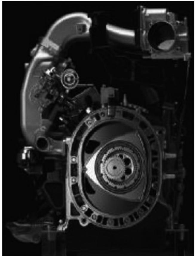
*Motor rotativo de inyección de hidrógeno del Mazda RX8E.*
