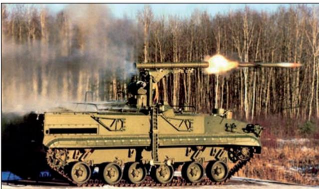
El Khrizantema ruso integra dos sistemas de guía alternativos (haz láser codificado y radar de ondas milimétricas).
