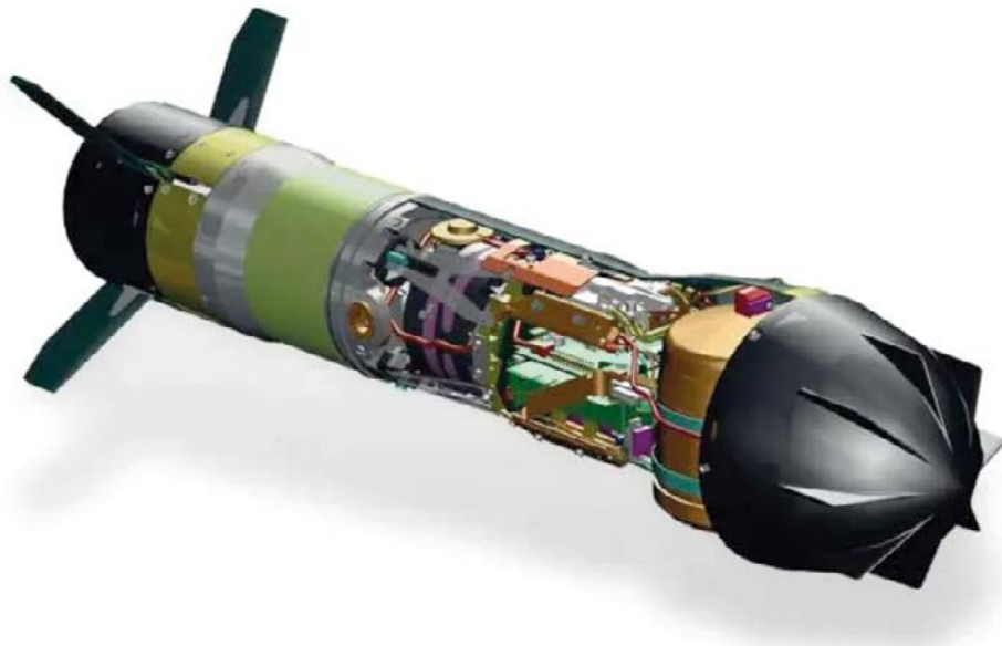
Ilustración n° 11: infografía proyectil del sistema N-LAW (Fuente https://root-nation.com/en/articles-en/weapons-en/en-nlaw-review/ )
