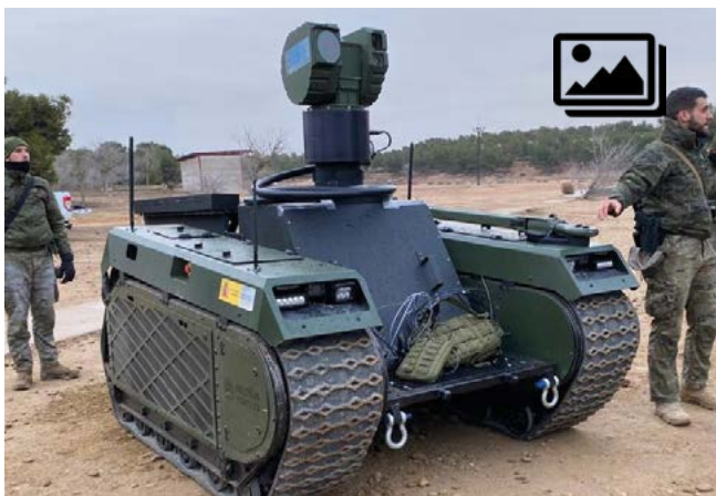
Detalle de alumbrado, la mochila con el módulo de control remoto. la V de remolque en su alojamiento de transporte y la cabeza de OTEOS con los bloques de electroóptica visible e infrarroja a la vista (Archivo RC España 11).
