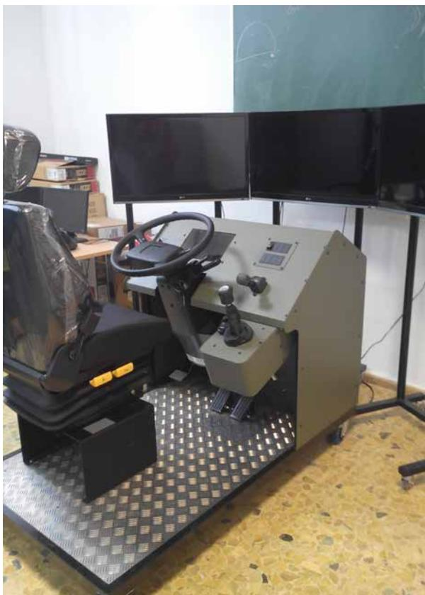
Figura 6.b—Simulador de conducción de vehículo pesado.
