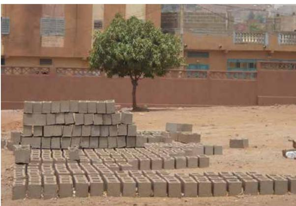
Figura 9.—Bloques de hormigón secándose al sol (Bamako).
