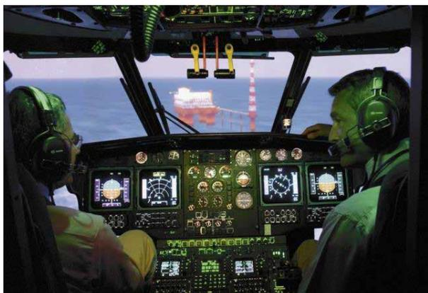
Figura 5.—Vista del interior del simulador Super Puma de Helisim (Fuente: <www.janes.ihs.com>).
