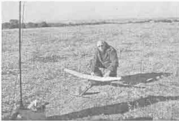
Orientando al MINI UAV al norte magnético para su posicionamiento mediante GPS interno
