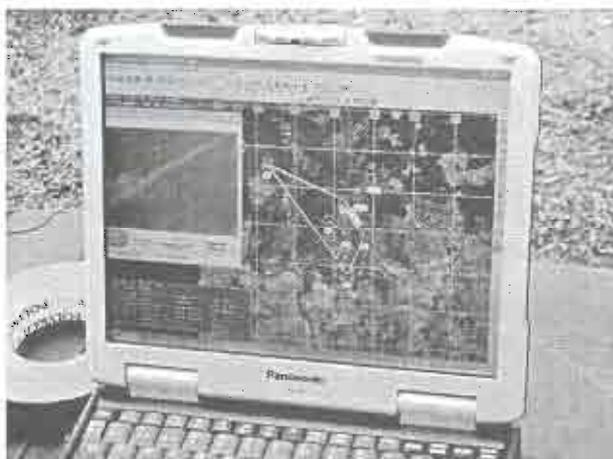
Programa FALCON WIEV en operación (ventana de cámara lateral activada, diamante de misión cargado, cartografía en base a ortofoto)
