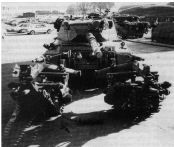
Figura 20.- Rodillo levantaminas montado en un carro Leopard 1 A4
