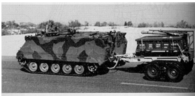
Figura 17.- Transporte de una manguera MICLIC mediante un remolque de alta movilidad arrastrado por un TOA M113 A3
