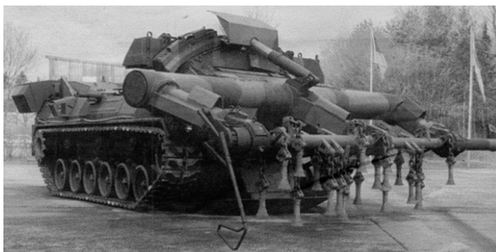
Figura 18.- "Keiler" en configuración de limpieza
