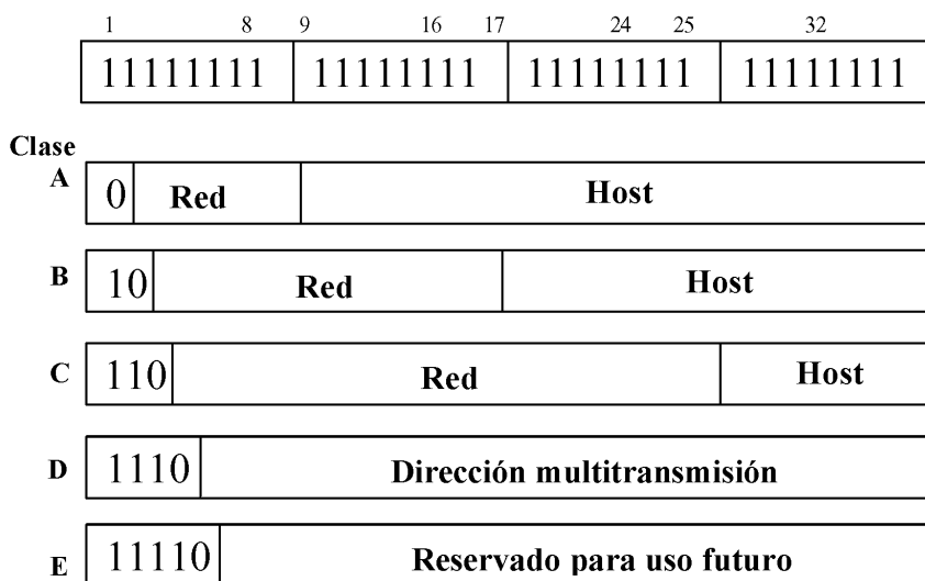
Figura 10. Formato de direcciones IP.
