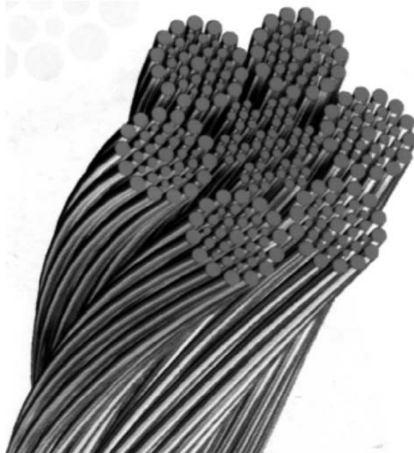
Croquis 6. Estructura del cable 6 x 36 + (7 x 7 + 0) WS.
