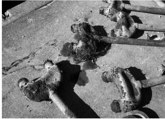
Detalle del mejillón-cebra adherido a las horquillas de acoplamiento.
