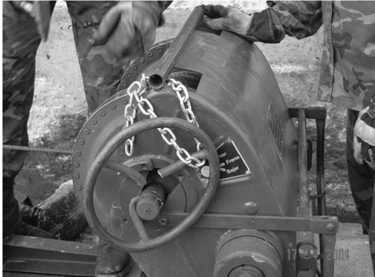
Foto 11. 17 ABR 04. FÓRUM-04. Detalle del volante del torno n.º 4, partido.
