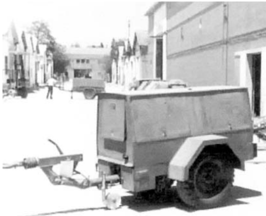
Grupo electrógeno TYCE Tipo «B».
