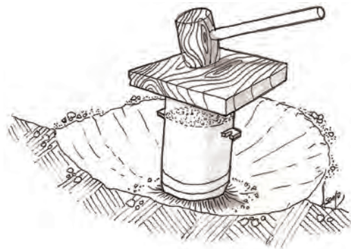
Fig. 8. Hincada del molde-extractor
