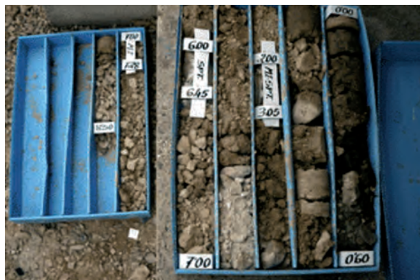
Fig. 4. Muestra extraída de una barrena
