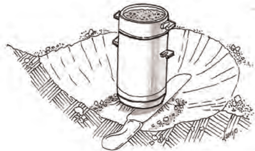
Fig. 9. Corte y separación del molde extractor
