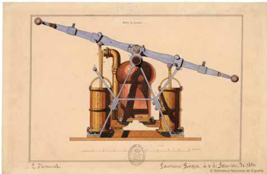
Bomba de incendios. Escuela Normal de Maestros de Instrucción Primaria de Manila. Dibujos ejecutados por los alumnos de la misma. Laureano Roque a 6 de Septiembre de 1886. Imagen propiedad de la Biblioteca Nacional de España. Signatura DIB/18/1/3242
