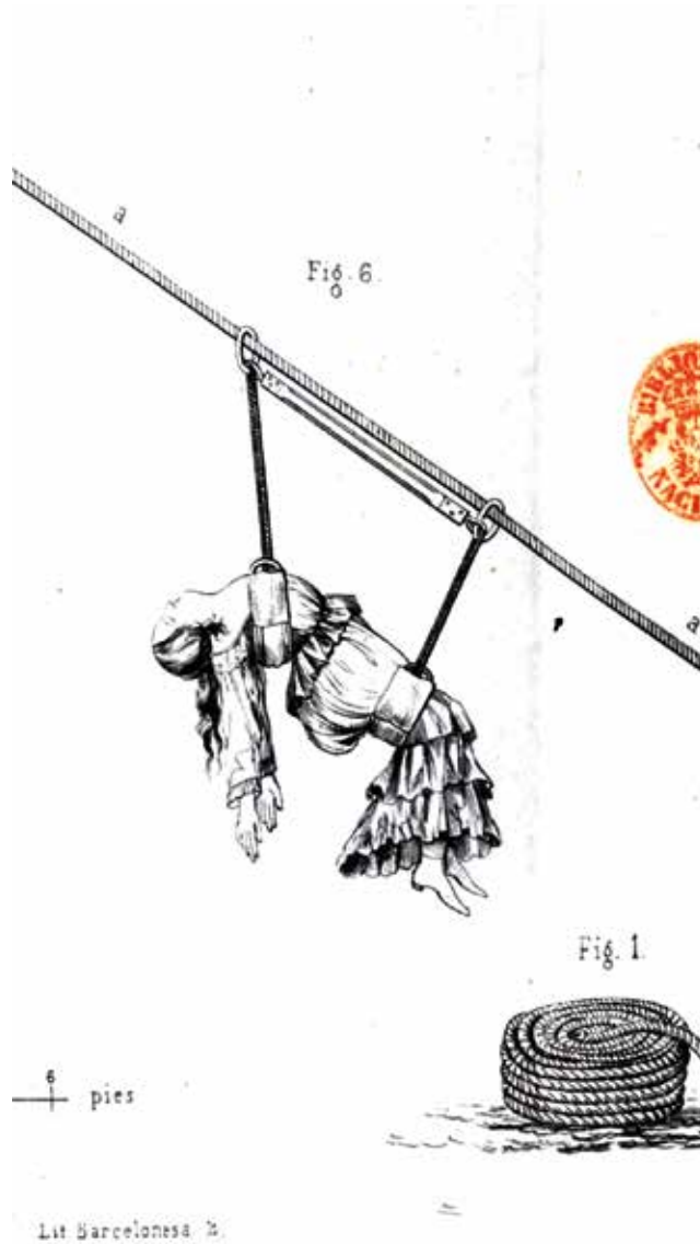
Lámina del Tratado de la estincion de Incendios de Antonio Rovira y Trias (1856), en la que se muestra el sistema de evacuación de personas. Imagen propiedad de la Biblioteca Nacional de España. Signatura 1/43600
