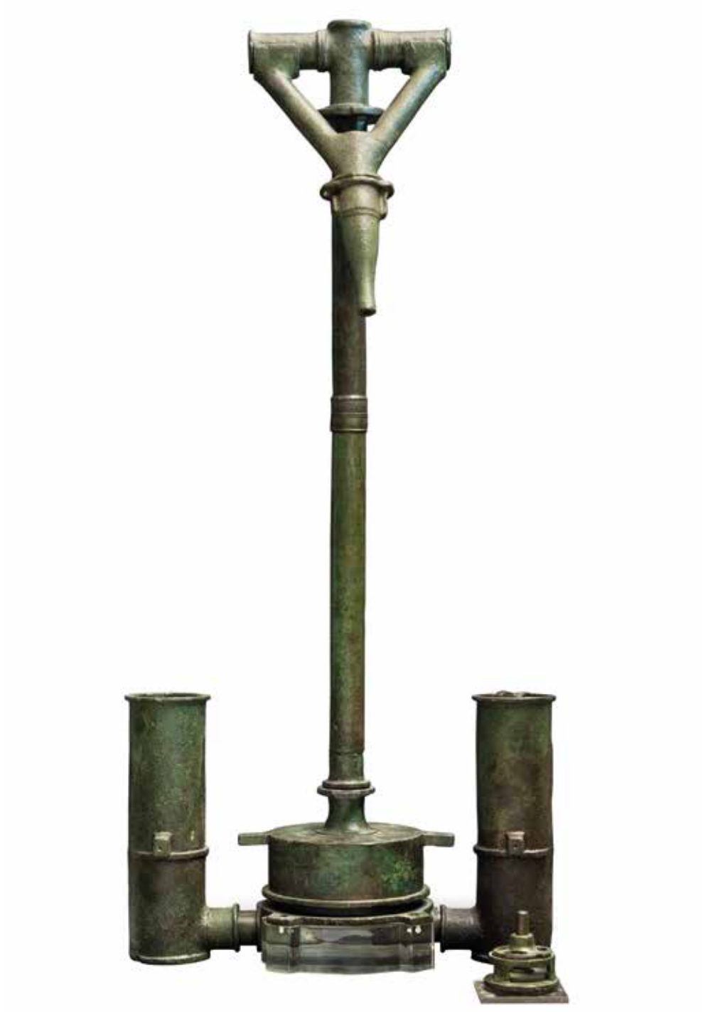
Bomba de Ctesibio localizada en la mina de Sotiel Coronada, en Calañas, Huelva. España. Ministerio de Cultura y Deportes. Museo Arqueológico Nacional. Signatura MANF1936_39_1. Fotografía: Raúl Fernández Ruiz
