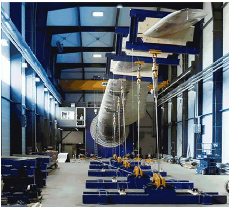
Foto 3. Fabricación de una pala de un aerogenerador.
