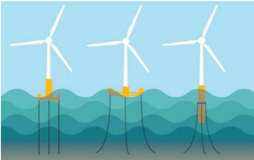
Figura 27. Tecnologías de eólica flotante, de izquierda a derecha: plataforma de apoyo en tensión; plataforma semisumergible y monopilar flotante o spar (AEE).
