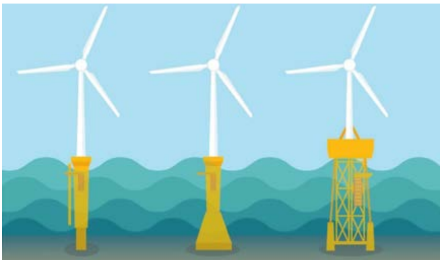
Figura 26. Tecnologías de cimentación fija, de izquierda a derecha: monopile, apoyo por gravedad y trípode (MITECO).
