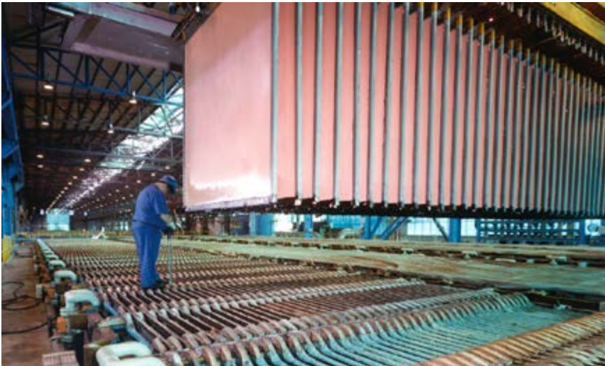
Figura 1. Empleo del sistema SX-EW en la recuperación electrolítica del cobre. Imagen de Asia Miner.
