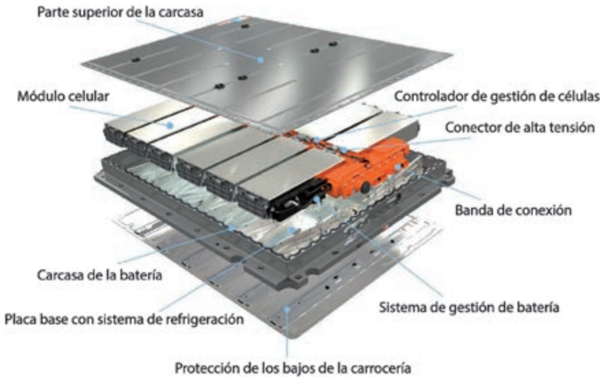
Figura 36. Configuración de un paquete de baterías de litio para un vehículo eléctrico (SKODA).
