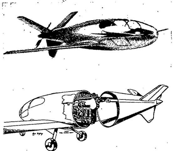
Aspecto del "Satellite". En el dibujo inferior puede apreciarse cómo han sido resueltos por su proyectista, en forma ingeniosa, los problemas relacionados con el entretenimiento del motor. Una palanca desconecta el sistema de mandos y el fuselaje, permitiendo así poder retirar la parte posterior del mismo.
