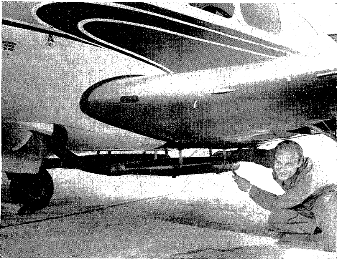
La Compañía aérea alemana "Lufthansa" ha acoplado unos silenciadores en los tubos de escape de los aviones que utiliza para instrucción de su personal. Con este equipo se reduce el ruido de los aviones en un 30 por 100.
