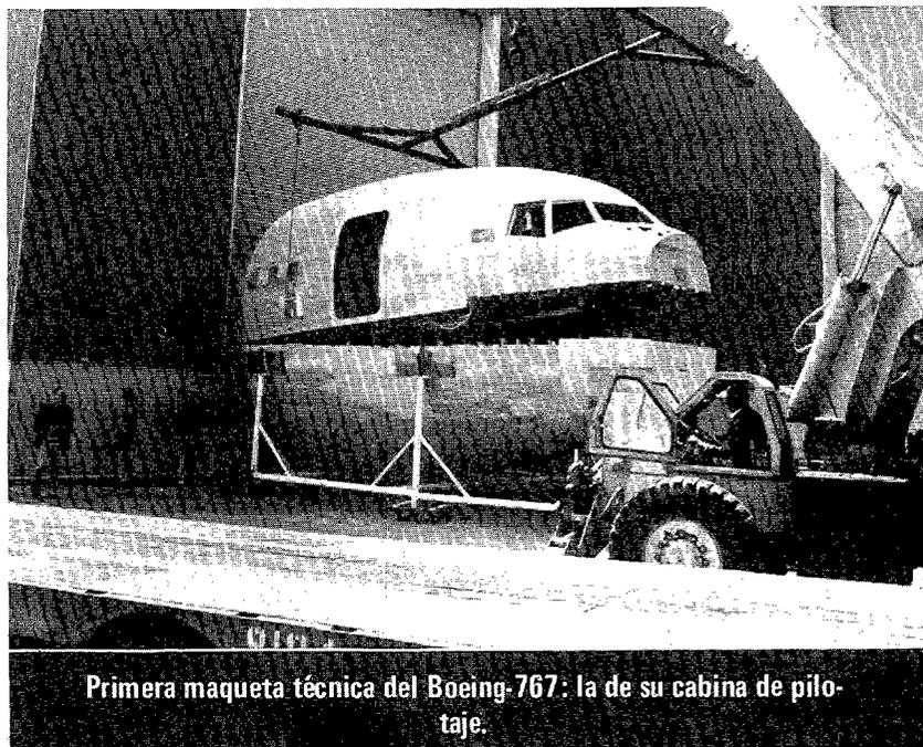
Primera maqueta técnica del Boeing-767: la de su cabina de pilotaje.
