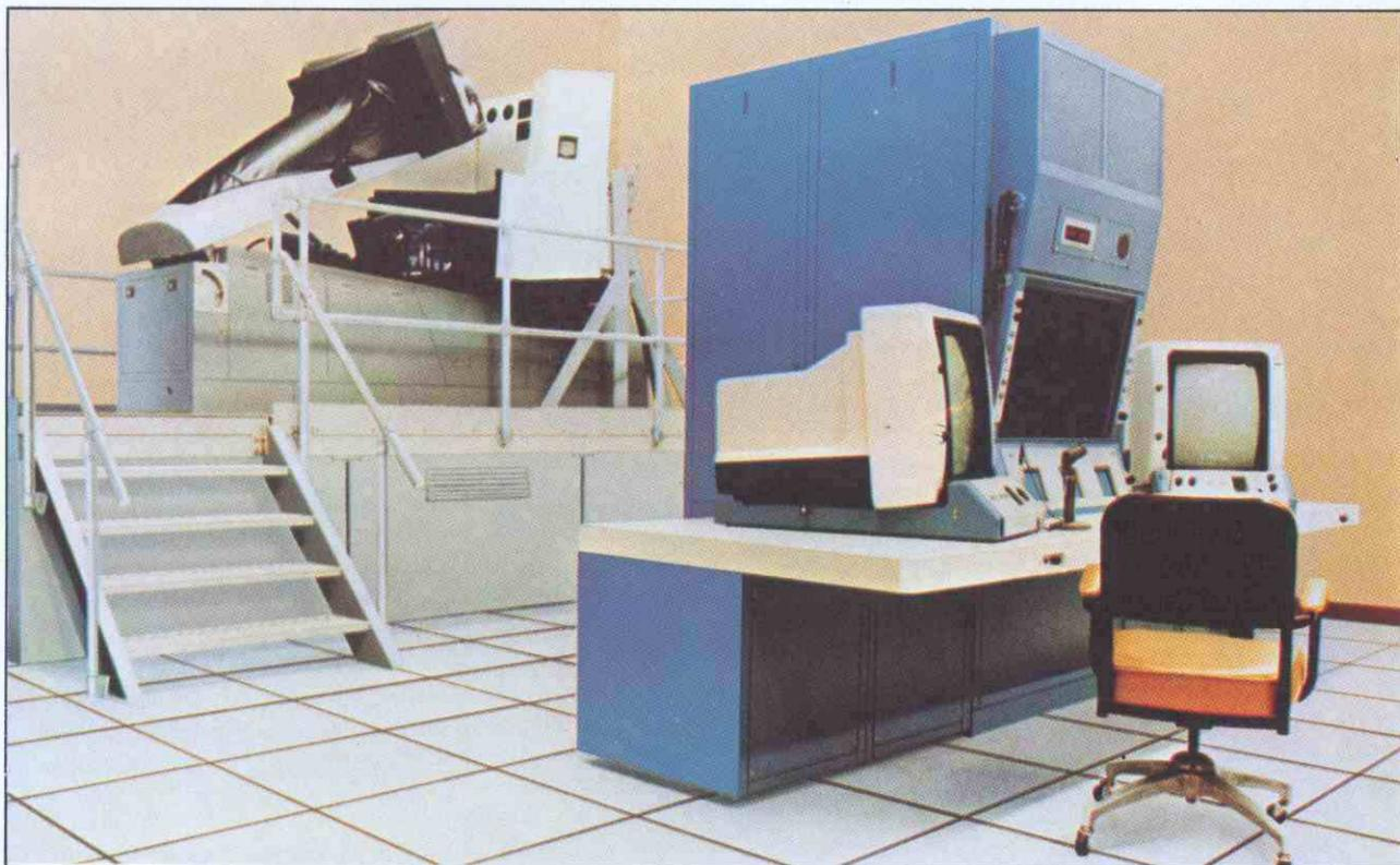
Puesto del Instructor y Cabina del Simulador Operacional de Vuelo del avión F/A-18 de la Marina de EE.UU., diseñado y construido por Sperry
