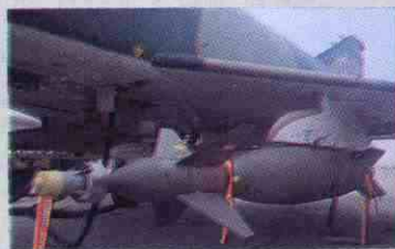
Bomba de guiado de láser de 1.000 Kg. bajo el plano de un Phantom
