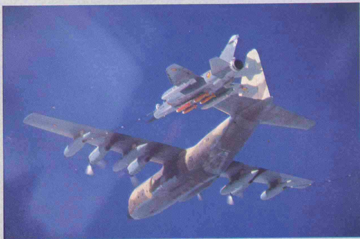
Operación de reabastecimiento en vuelo de un avión F-1 del Ala 46. El avión nodriza es un C-130 Hércules
