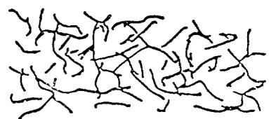
**D.M.C. O PREMIX:** PASTA FORMADA POR UNA COMBINACIÓN DE RESINAS, REFUERZOS DE F. CORTADAS Y DETERMINADOS COMPUESTOS QUÍMICOS AUXILIARES.
