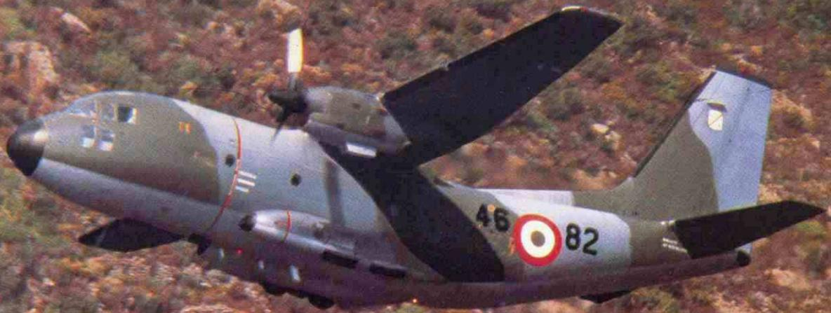
**Aeritalia G-222, avión que equipa parcialmente la 46 Aerobrigada de transporte y que tiene una capacidad de carga máxima de 9.000 kg**
