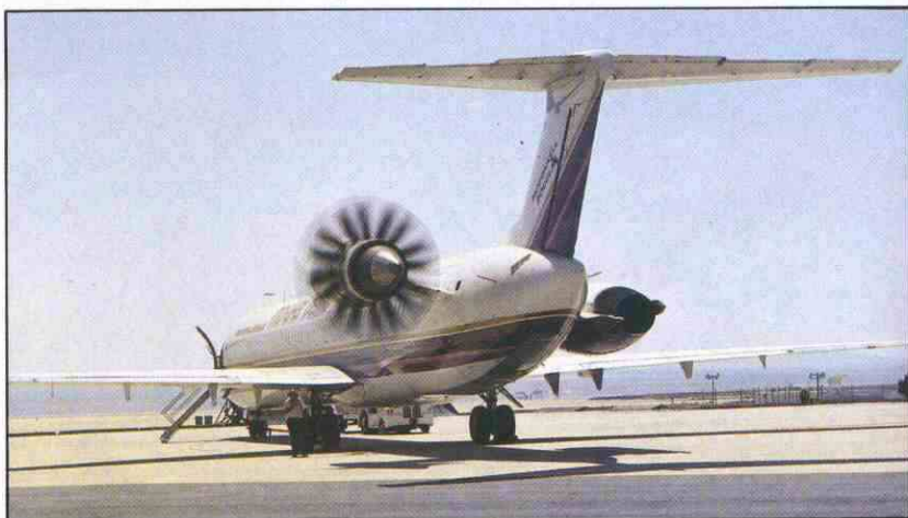
Avión Mc Donnell Douglas MD 81 sobre el que están haciendo pruebas de un motor UDF de General Electric. Con la configuración de ese motor en posición izquierda, ha estado en Farnborough 88. La NASA y General Electric han manifestado que este tipo de motor tiene aplicación a aviones militares.
