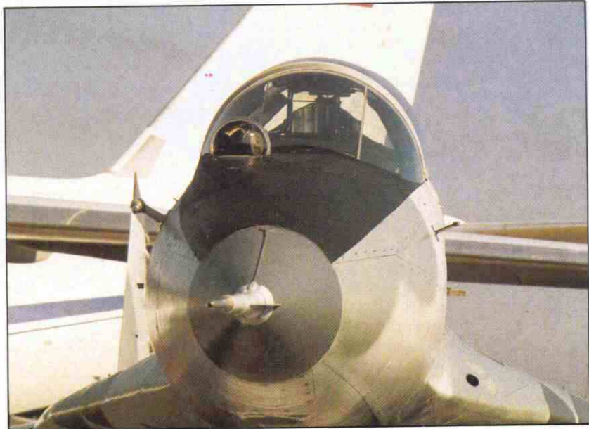
Primer plano del morro del MIG-29 con el sistema RST de búsqueda y seguimiento de blancos por infrarrojos.
