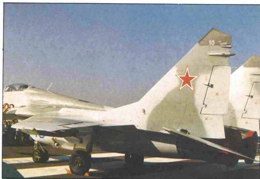
Detalle de las colas del MIG 29 con las antenas del sistema alertador de radar Sirena III.
