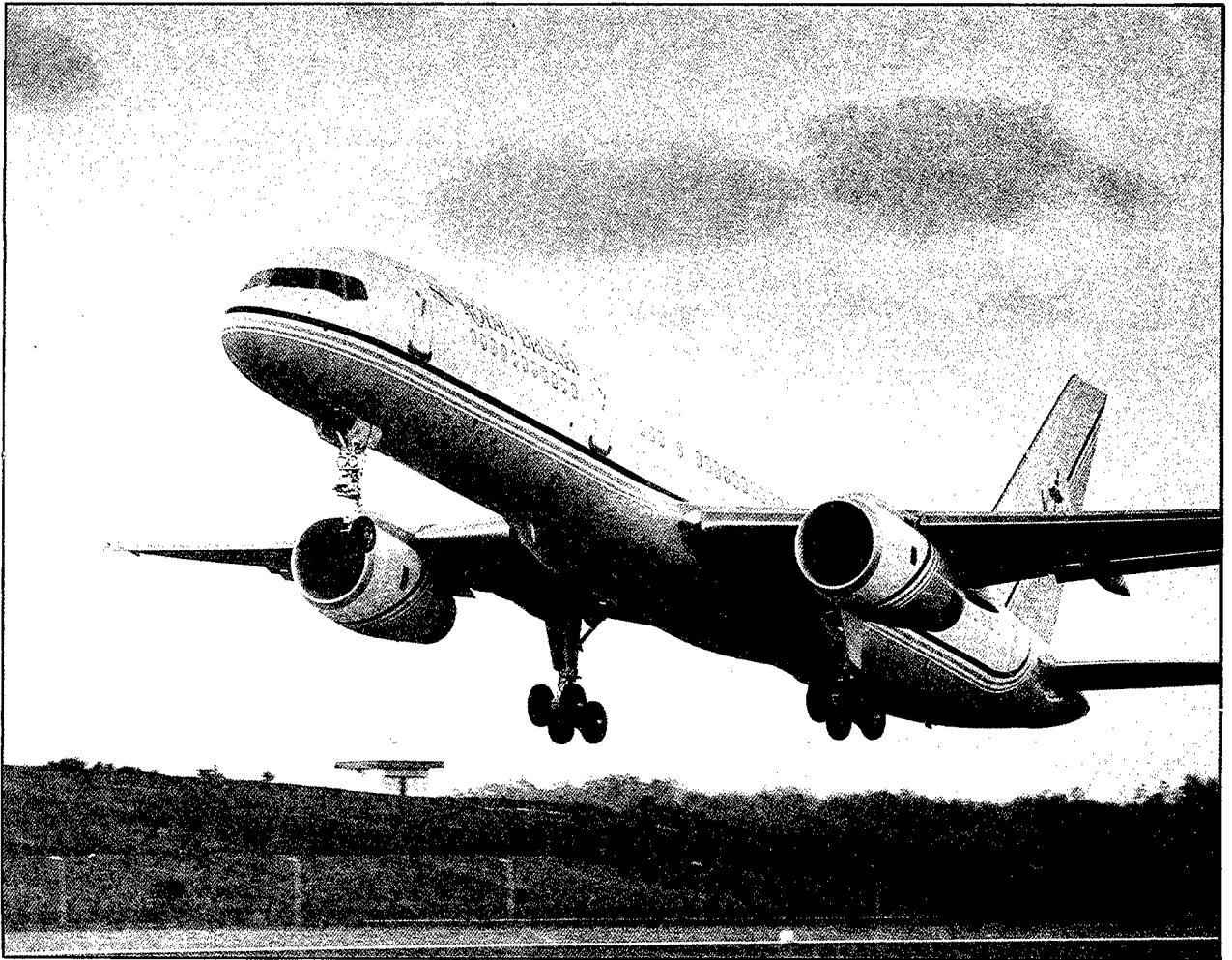
Avión Boeing 757, que con motores Rolls Royce 535 E4, está certificado como avión de características EROPS (Extended Range Operations), y vuelos transatlánticos.
