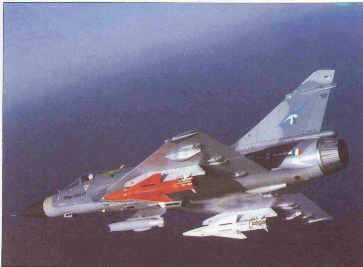
Entre los sistemas de armas que puede llevar el Mirage 2000, está el misil AS 30 LASER, como puede apreciarse en la fotografía.
