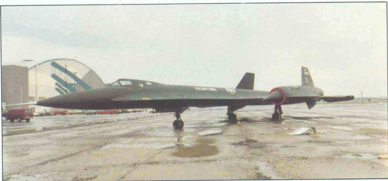
Una de los prototipos YF 12A, interceptor de bombarderos supersónicos. De este proyecto saldría luego el famoso SR 71A "Blackbird" de reconocimiento estratégico.
