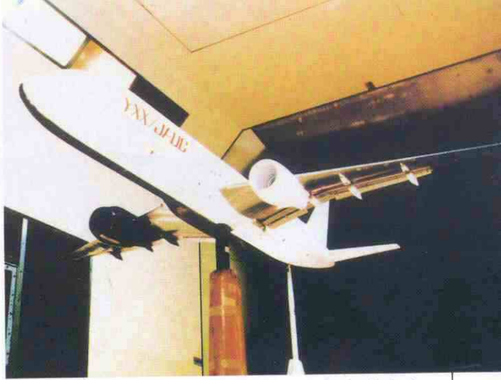
Fig. 12. Maqueta sometida a pruebas en túnel aerodinámico, para el programa YXX-7J7.
