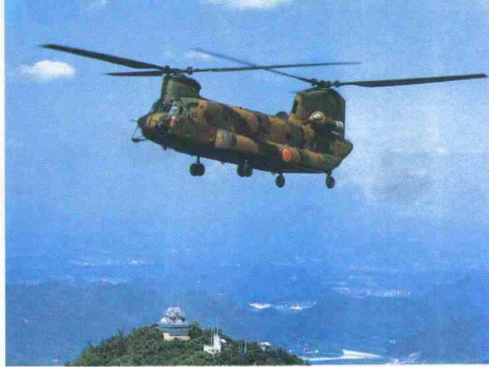
Fig. 15. El CH-47J, fabricado por Kawasaki, bajo licencia de Boeing-Vertol. Los motores son T55-K-712.
