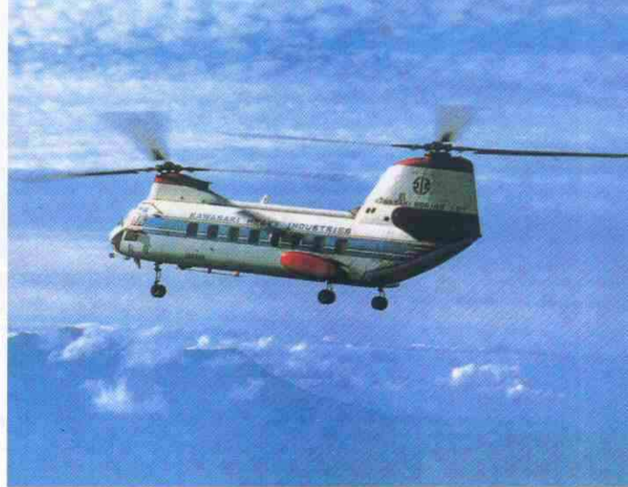
Fig. 19. El Consorcio Kawasaki-Boeing está fabricando el KV107IIA, helicóptero multiuso, con capacidad para 28 pasajeros.
