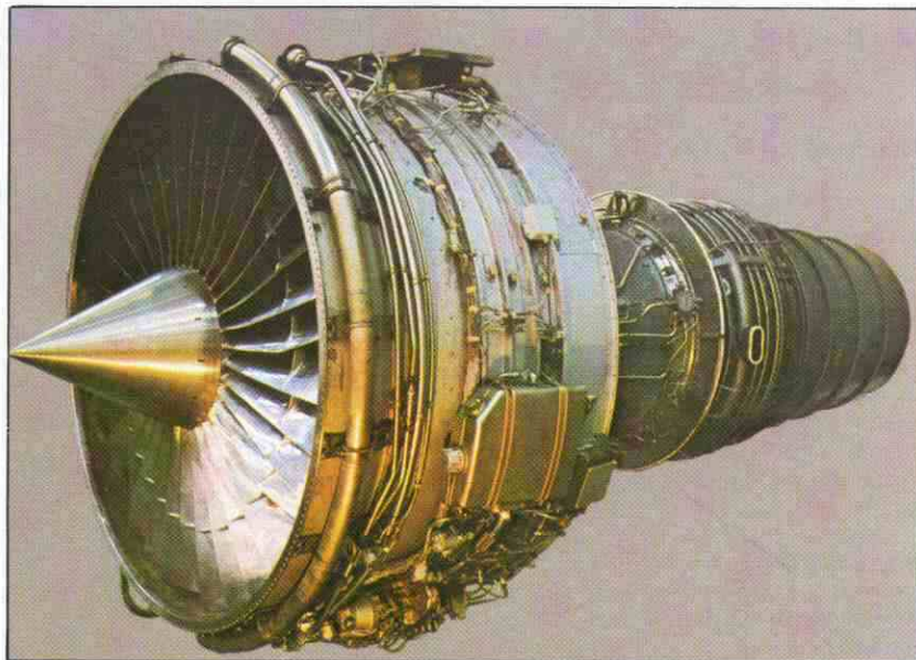
Reactor de doble flujo Lotarev D-18T.
