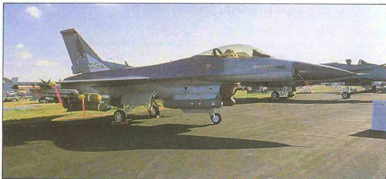
El F-16 equipado con un pod LANTIRN bajo el motor.
