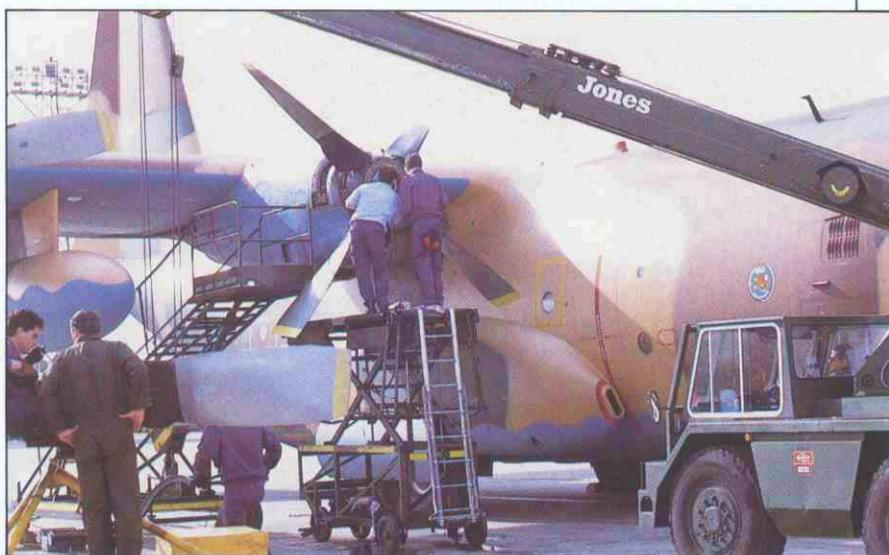
*Un equipo de mantenimiento, en un alarde de eficacia, cambia una hélice en Chipre sin alterar prácticamente el desarrollo de la misión.*
