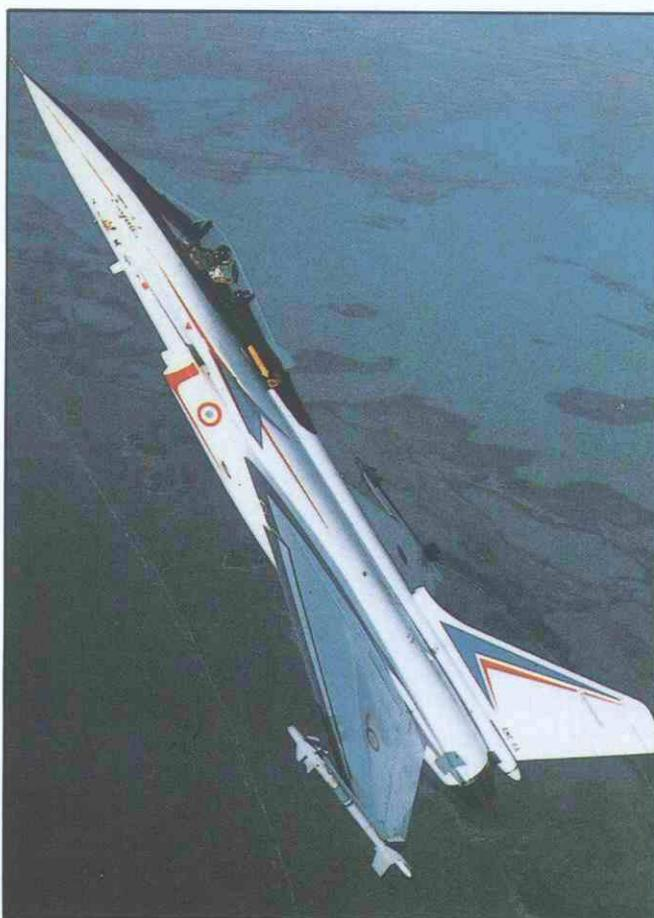
Fig. 5. El "Rafale" de Marcel Dassault efectuó el primer vuelo con dos motores diferentes, un M-88-2 de SNECMA y un F 404-GE-400, en Febrero de 1990, para comprobar las actuaciones del M-88-2, que propulsará los "Rafale" de producción.
