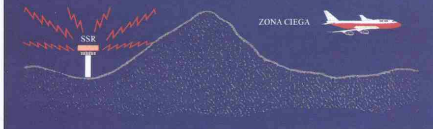
Fig. 2. La orografía del terreno puede dar lugar a zona ciega donde la aeronave no puede ser detectada.
