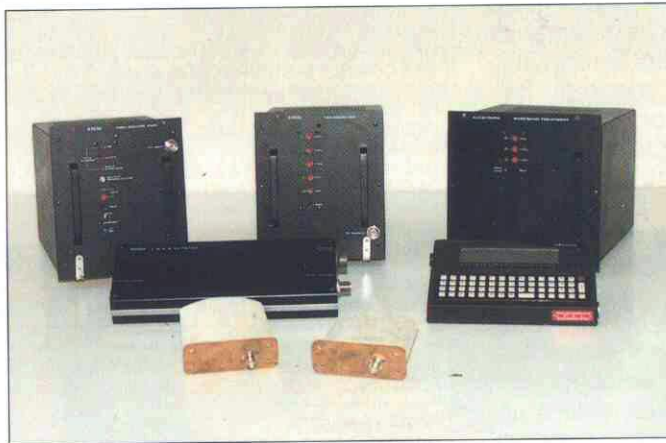
Fig. 9. Equipo de comunicaciones satélite de a bordo PRODAT/PROSAT utilizado en la segunda fase
