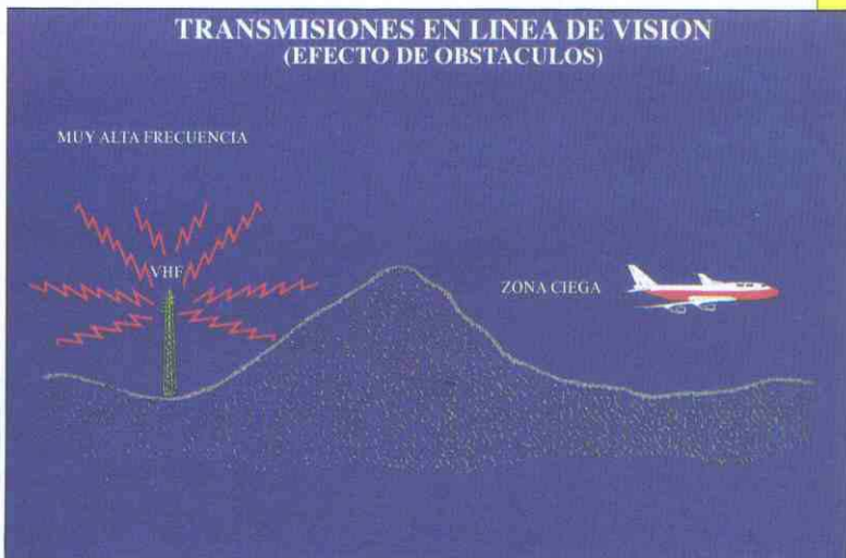
Fig. 2. La orografía del terreno puede dar lugar a zonas ciegas donde se pierde la comunicación con la aeronave.
