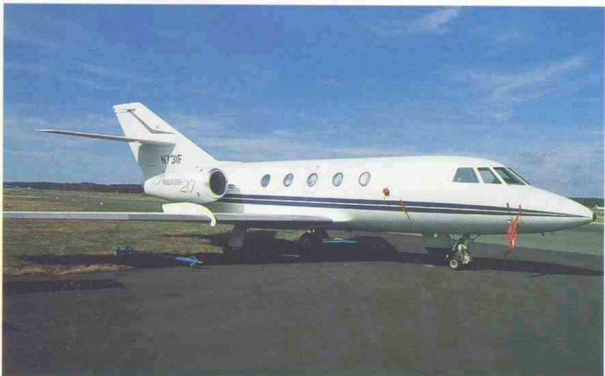
Las aeronaves de combate constituían en 1991 el 75% del volumen de negocios de Dassault. Si todo sigue el ritmo previsto, en 1996 sólo un 55% de su actividad estará relacionada con los productos militares. En la fotografía el Falcon 20C equipado con motores Garrett TFE731.
