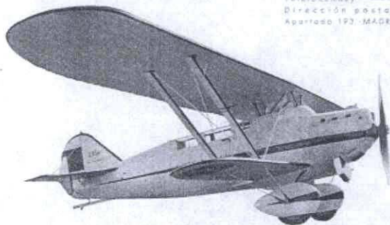
Avión Super-ligero BRÉGUET C. A. S. A., con depósito para 5.500 litros de gasolina y depósito para radio de acción de 5.500 kilómetros.
