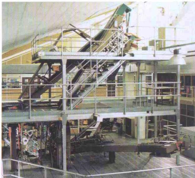
*Simulación del estabilizador y timón de dirección.*
