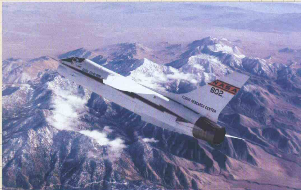
El 25 de mayo de 1972 este LTV F-8 Crusader de la NASA se convirtió en el primer avión del mundo que voló provisto de un sistema «fly-by-wire» acoplado a un ordenador digital. La NASA había comenzado a estudiar en 1960 ese programa experimental cuyo principal valedor fue el ex-astronauta Neil Armstrong. -NASA Dryden Flight Research Center-
