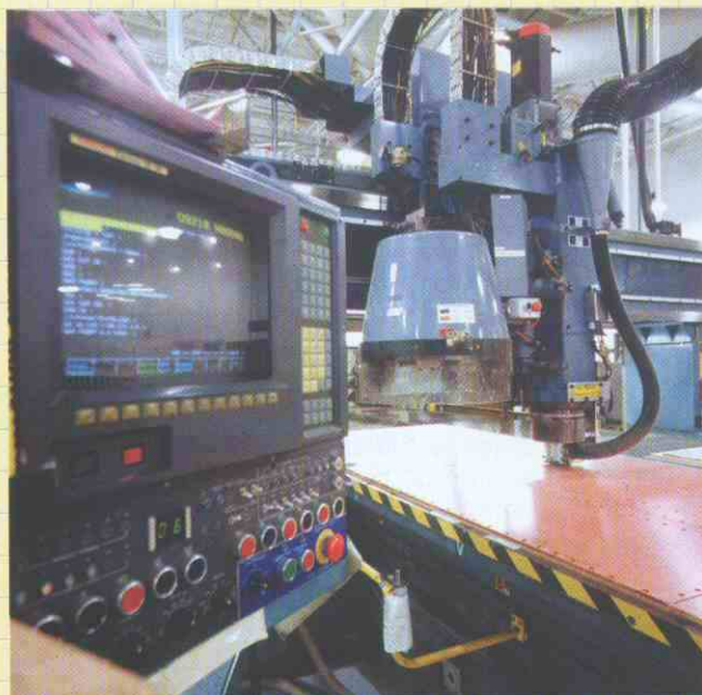
Máquina de control numérico usada por Boeing en la producción de pisos para sus aviones. El empleo de ese tipo de maquinaria de precisión es tradicional en la fabricación aeronáutica. -Boeing-
