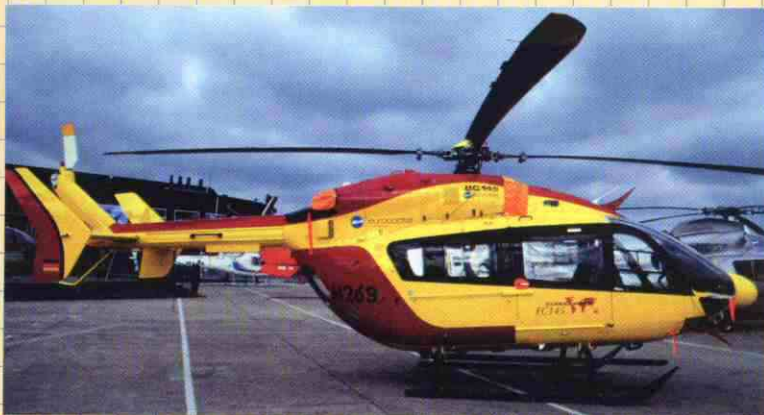
Las líneas del Bk.117 son patentes en el EC145, a pesar del aumento de tamaño de la cabina.
