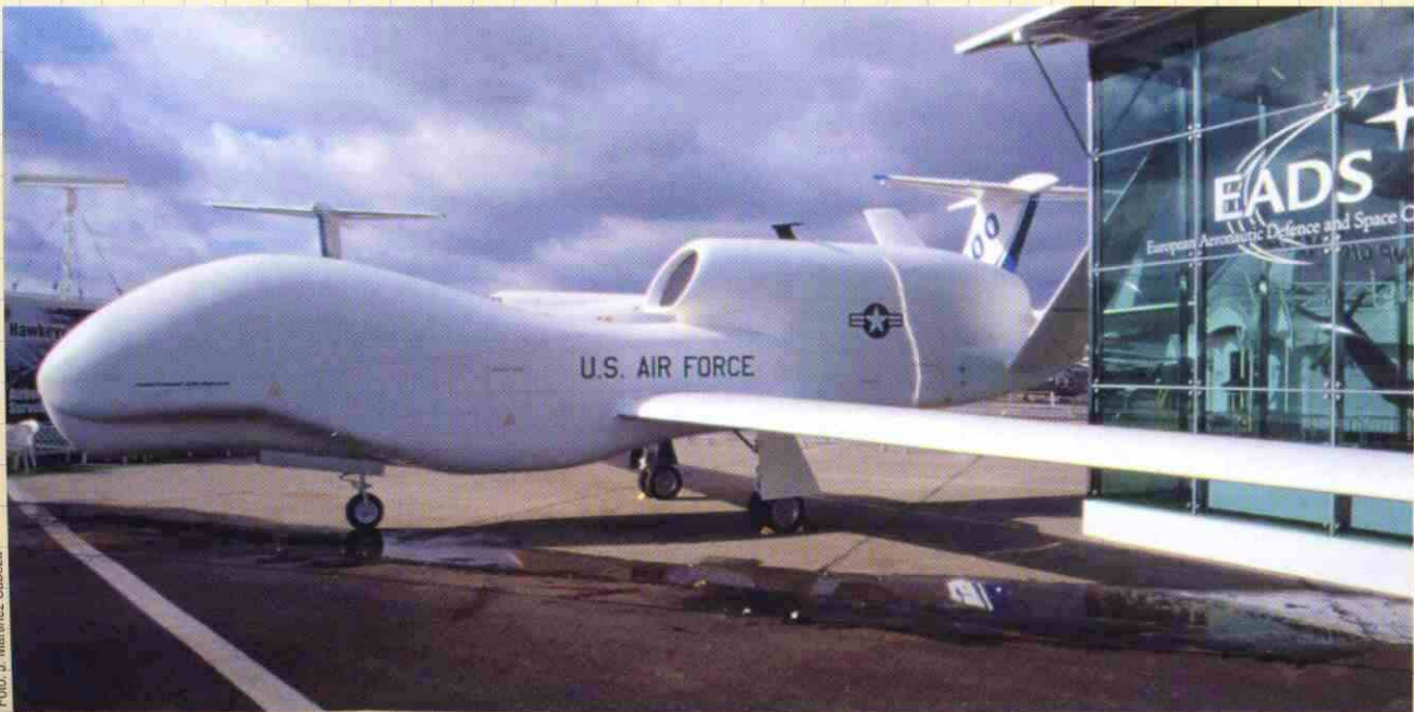
Impresionante sus 35 metros de envergadura, el Global Hawk se puede considerar como el primer HALE (High Altitude Long Endurance).
