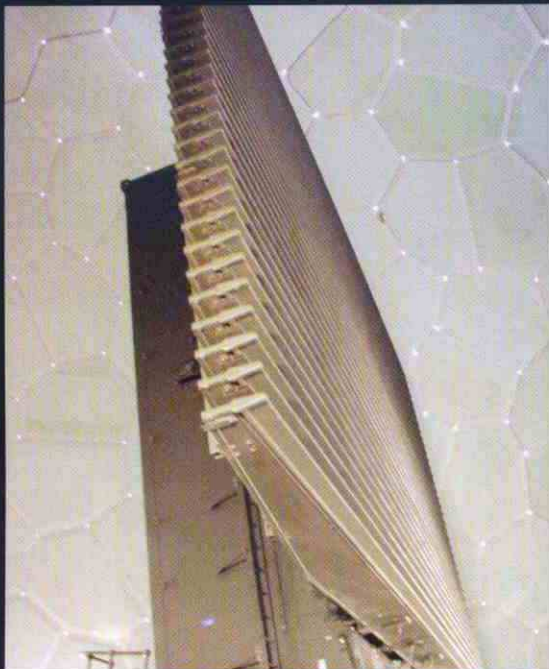
Antena del radar Lanza en el interior del radomo.
