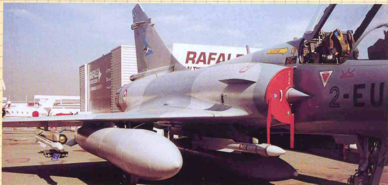
Obsérvese el misil MICA RF en posición estática del M-2000-S
