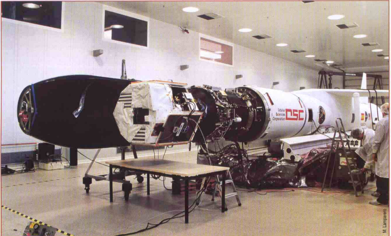
Cohete lanzador del Minisat 01. En la fotografía podemos apreciar la parte delantera del cohete lanzador del Minisat 01. Este cohete fue lanzado desde un avión Lockheed-1011 en vuelo el 21 de abril de 1997 y el programa constituyó un rotundo éxito. En la fotografía podemos distinguir en la parte delantera el satélite con los paneles solares plegados. Detrás puede observarse los dispositivos de control y elementos de propulsión del cohete.
