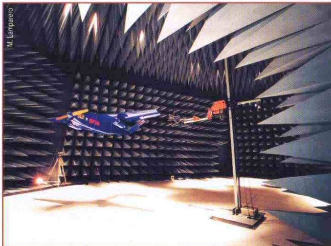
CAMARA DE COMPATIBILIDAD ELECTROMAGNÉTICA- El laboratorio de ensayos de compatibilidad electromagnética en cámara es un laboratorio con más de 25 años de experiencia en el desarrollo de medidas de compatibilidad electromagnética (EMC) sobre equipos y sistemas eléctricos y electrónicos, tanto para aplicaciones de carácter militar como civil. Cuenta entre sus instalaciones con una Cámara Semianecoica con unas dimensiones de 24x14 metros y 10 m. de altura, permitiendo realizar ensayos a 1,3 y 10 m. de distancia a equipos y sistemas hasta 12.000 kg. de peso. El laboratorio está acreditado para el desarrollo de ensayos de emisión y susceptibilidad por ENAC y por la FCC americana (Federal Communications Commission), siendo además Organismo Evaluador de la Conformidad dentro de los Acuerdos de Reconocimiento Mutuo existentes entre diversos países y la Unión Europea.
