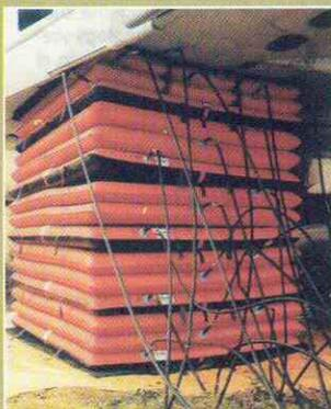
daño sufrido en éstos o por haber quedado empotrado en la tierra, la aeronave necesita ser levantada para poder repararla en el lugar o para trasladarla mediante la utilización de los equipos destinados para este cometido. Normalmente, la posición del avión en referencia al suelo impide la colocación, en los puntos que el fa-
