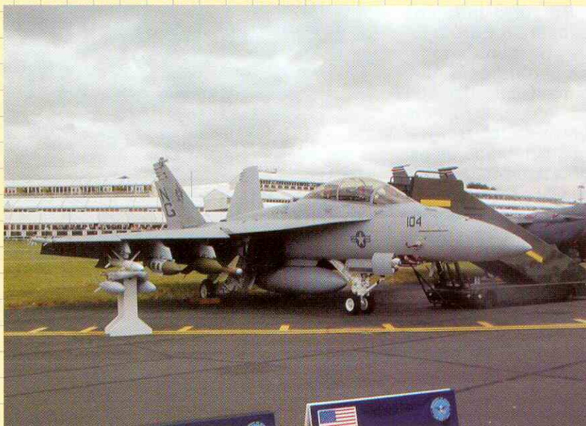
El EF-18F, con sus tomas de aire cuadradas y tres estaciones bajo cada plano.
