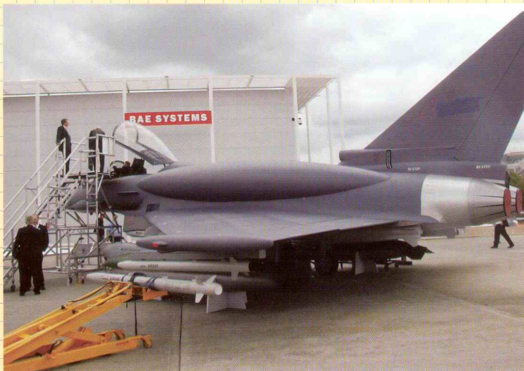
Maqueta a tamaño real del EF-2000 con depósitos "conformados", para proporcionarle mayor alcance; una posible opción para el desarrollo de la tercera tranche.
