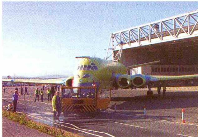
forzada y se le ha instalado además un nuevo tren de aterrizaje Messier-Dowty. Las compuertas de la bodega de bombas no han sido todavía instaladas
