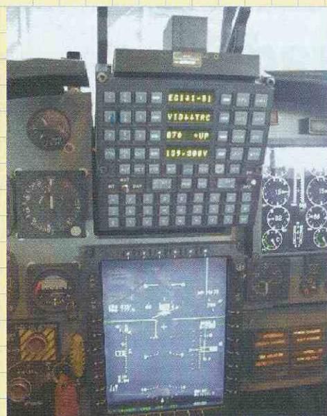
Display principal y panel de control de equipos de aviónica y diseño inicial de cabina, muy próximo a su configuración final.
