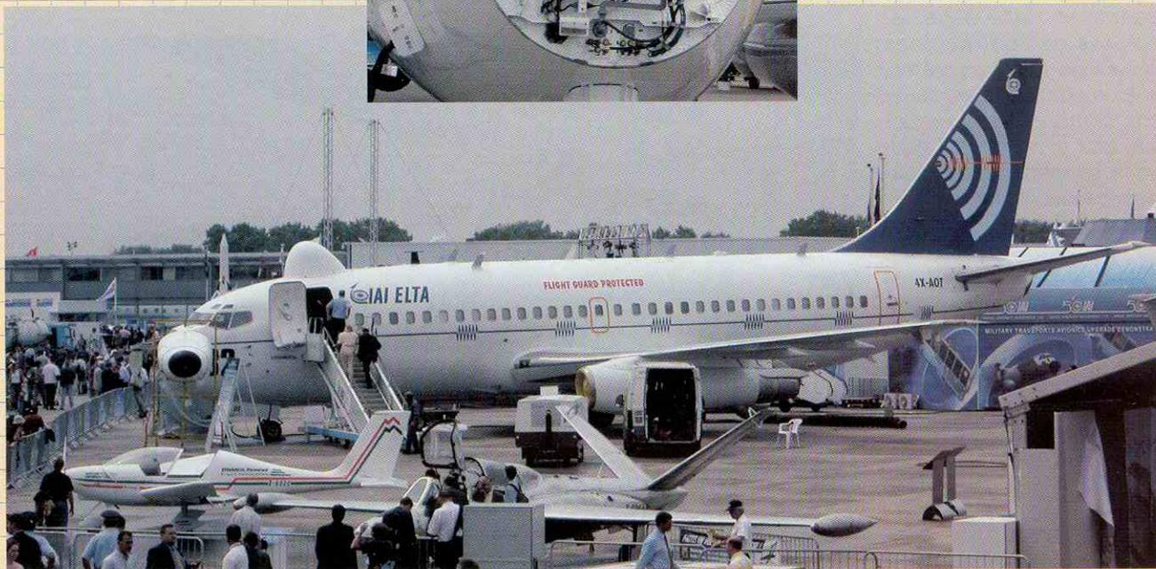
*El Boeing 737 equipado por IAI/ELTA hacia su primera aparición en público. El avión está dotado de todo tipo de sistemas para inteligencia de señales y de imágenes, patrulla marítima, vigilancia y control aéreo; cuenta además con el sistema antimisiles "Flight Guard", diseñado para la protección de aviones tanto de pasajeros como de carga.*
