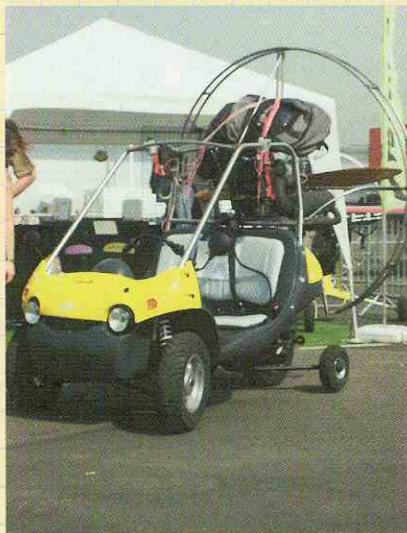
*Uniendo un minicoche a un motor trasero de hélice y a un parapente se obtiene como resultado el añorado coche volador, por otra parte mil veces inventado.*
