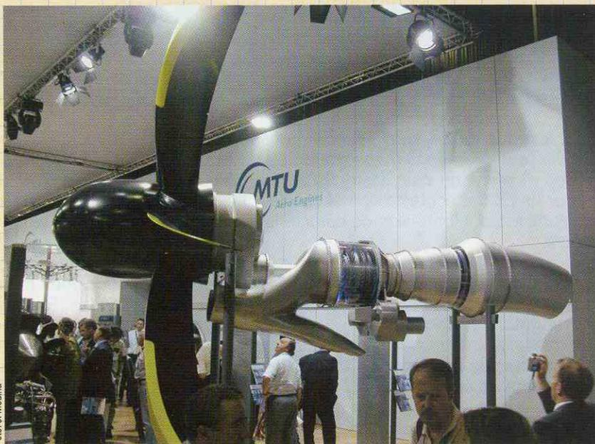
TP400-D6, motor seleccionado para el Airbus A400M.
