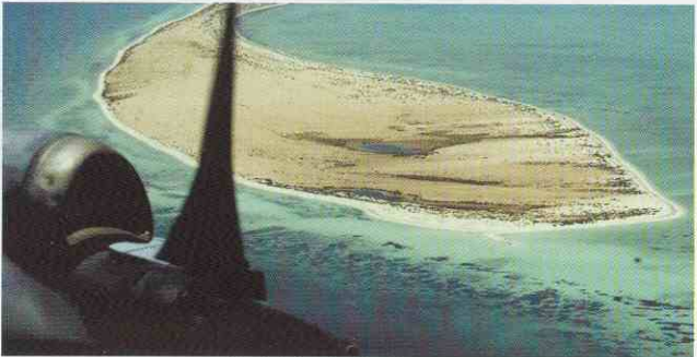
Isla típica del Mar Rojo en cuyas proximidades vuela el P-3B de la Unidad. Obsérvese que el motor 1 está parado; práctica habitual para incrementar el tiempo de permanencia en zona. Las misiones sobre dicho escenario sobrepasan las 11 horas de vuelo.
