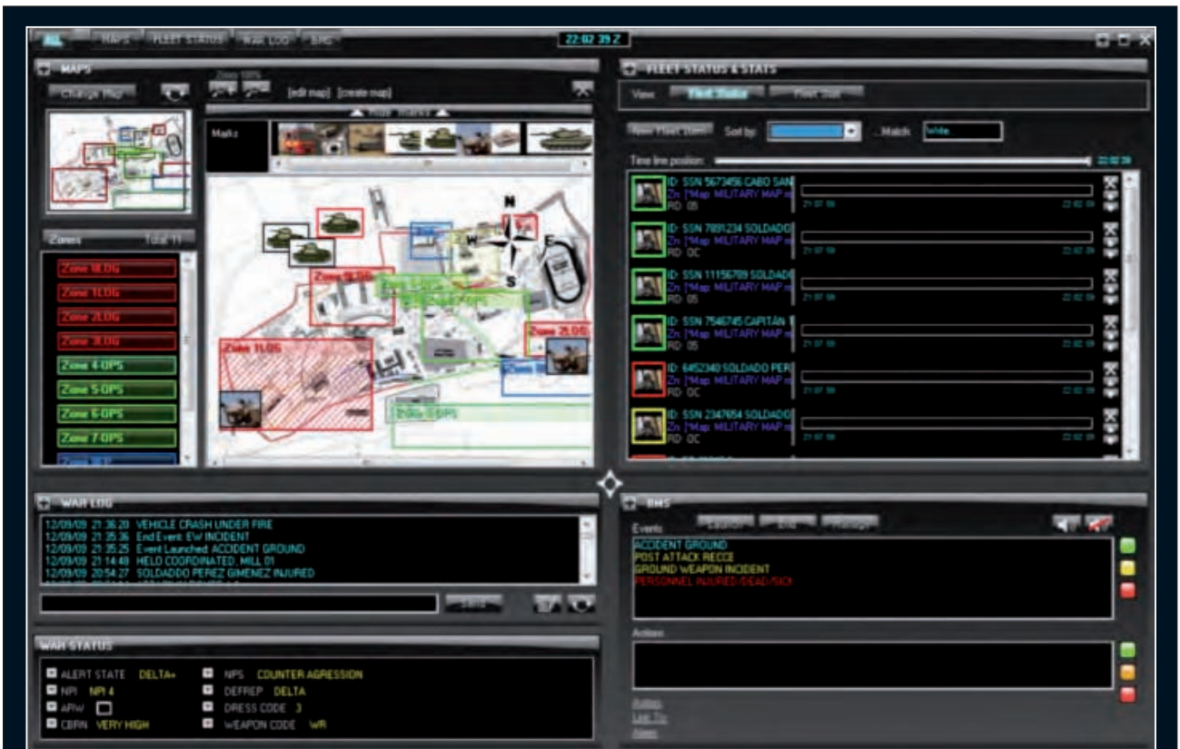
Figura 14. Elementos que componen un pelotón de infantería localizados en la misma zona próxima a una base militar, resuelven un evento accidente con herido. Al seleccionar todos los elementos de esa zona o de esa misión, nos aparecen personal y vehículos, cada uno con su estatus. Podemos saber cuáles son los datos del herido o del vehículo siniestrado pinchando en su icono, sin tener que recurrir a otro sistema.
