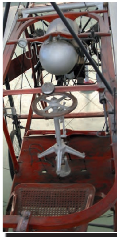
Detalle del asiento del piloto y mandos de vuelo.
