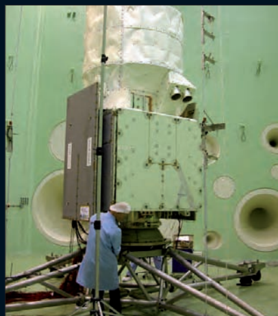
El Aeolus para pruebas acústicas. (Foto: ESA)
