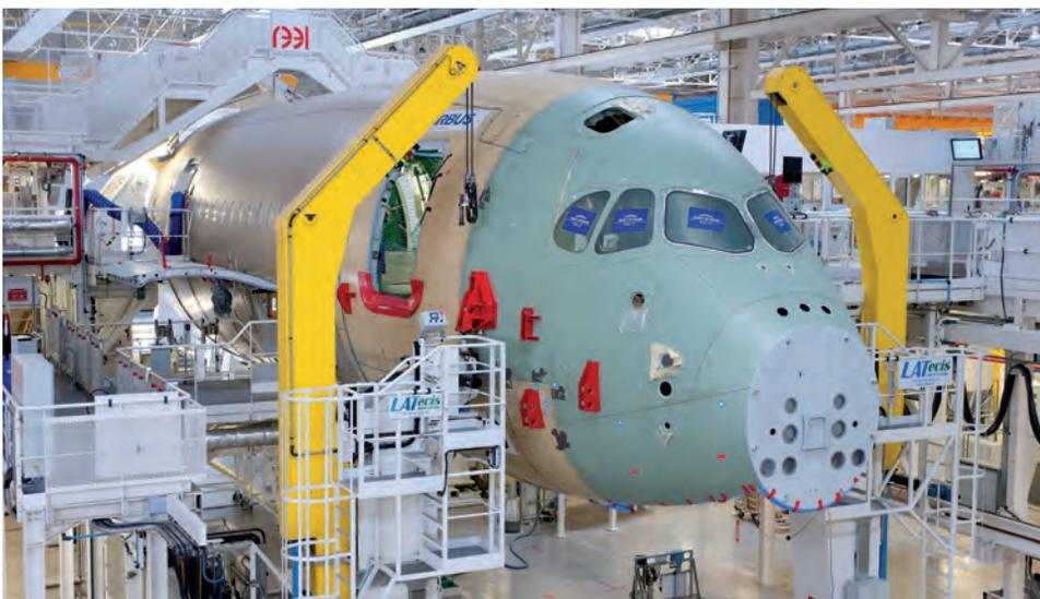
El primer A350 XWB durante el proceso de unión del fuselaje central y el fuselaje delantero en Toulouse. -Airbus-
