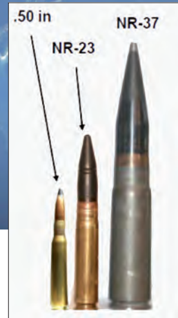
Comparativa entre los proyectiles M3 (cal 0.50) del F-86 Sabre y NR-23 y NR-37 del MiG 15.
