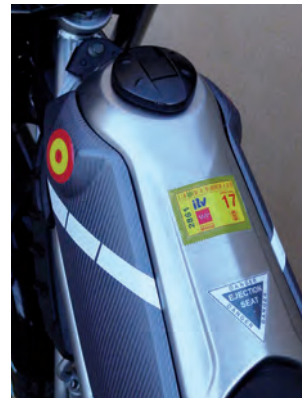
Detalle del depósito con el aviso de "Ejection Seat" junto al asiento.
