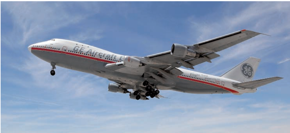
El Boeing 747-100 banco de pruebas de GE Aviation despegó por vez primera con un motor LEAP-1B en la posición del motor nº 2. -Boeing-
