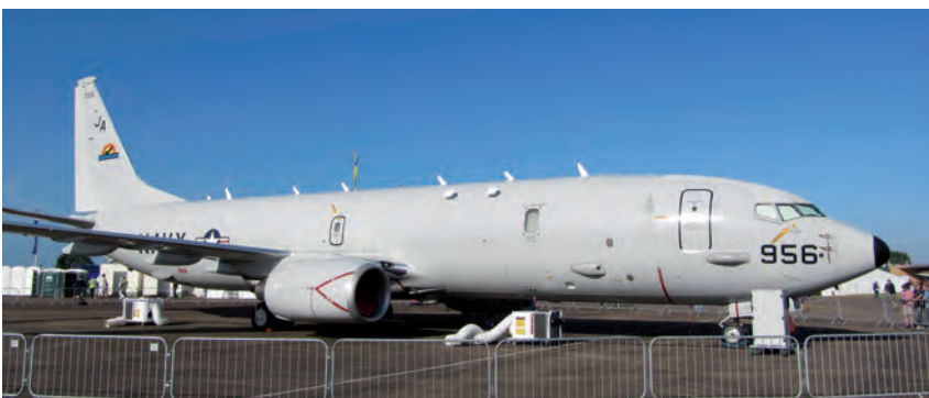
Poseidón: El rey de los Mares. El P-8A Poseidon es un avión basado en el Boeing 737-800 de largo alcance, multi-misión, destinado a desempeñar tareas tanto de lucha anti-submarina como guerra anti-superficie.
